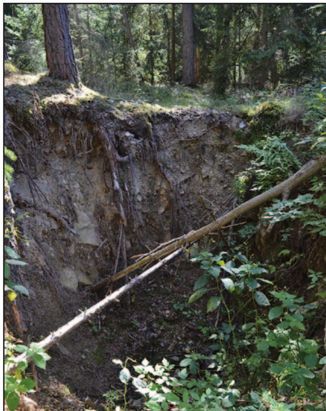
Částečně propadlá 30 m šachta pro průzkum uranu; foto Josef Korn
